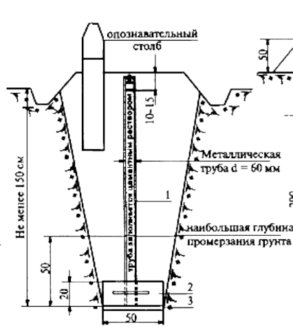
Центр пункта триангуляции, полигонометрии 4 класса для районов глубокого промерзания грунта (выше 1,5 м)
