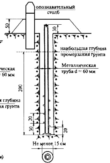
Центр пункта триангуляции, полигонометрии 4 кл. и 1, 2 разрядов и грунтовой репер нивелирной сети III-IV классов для районов многолетней мерзлоты
